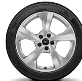
U72 鑄造鋁合金輪圈, 搭配 225 / 40 R18 輪胎
