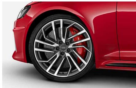
PC3 陶瓷前輪煞車碟盤 (搭配紅色卡鉗)
