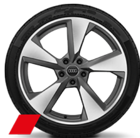
44T Audi Sport 鑄造鋁合金輪圈 搭配 255 / 35 R19 輪胎
