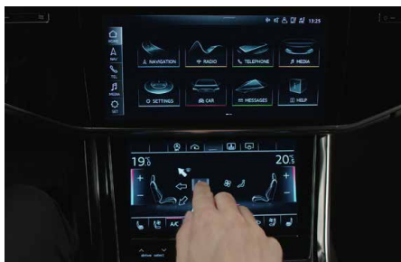
9AQ 四區恆溫空調
